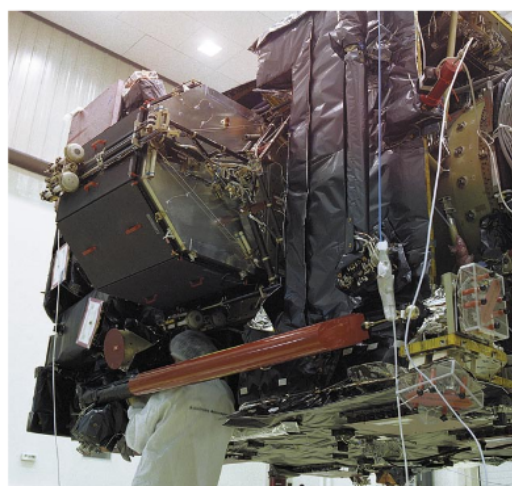
La sonde Rosetta et son atterrisseur Philae en intégration. © ESA.
